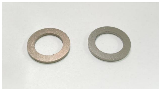
トロイダル形状(左側)とブロック形状(右側)に作製した圧粉磁性体
