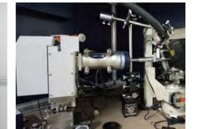
全自動水平型多目的X線回折装置(株)リガク製 Smart Lab 3G
