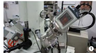
電界放出型の電子プローブマイクロアナライザで、波長分散型X線分光器(WDS)で取得したデータから元素濃度や化学組成をマッピングするソフトウェアを装備しています。更に本学寺内教授らが開発した軟X線分光器(SXES)を備えており、Liなどの軽元素の解析も可能です。
