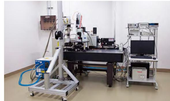
蛍光寿命マッピングにより化合物半導体の組成・欠陥・量子井戸・不純物・結晶性等の評価を行う装置です。試料を冷却しながらの測定も可能です。
