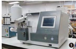
電界放出型の走査電子顕微鏡と試料作製に有用なクロスセクションポリリッシャです。オプションにエネルギー分散型X線分析装置(EDS)、結晶方位解析装置(EPDM)を備えており、トランスファーベッセルも用意しています。
