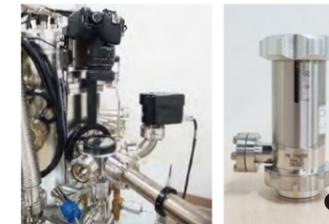
試料最表面の化学結合状態を調べるための多機能走査型X線光電子分光分析装置です。任意の50か所までの測定位置に対して連続自動測定ができます。トランスファーベッセルを用意しています。
