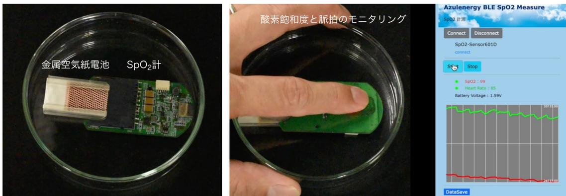
図 3. 金属空気紙電池による SpO<sub>2</sub> 計の駆動と酸素飽和度・脈拍のリモートモニタリング。
